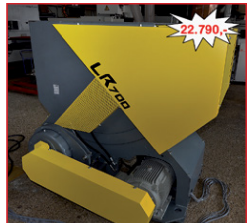
UNTHA Zerhacker LR700, Neumaschine, CE Zeichen, 18,5kW, Rotorbreite 700mm, Rotor Ø 300mm, Einfüllöffnung 700x1.065mm, 19 Messer, schwenkbarer, hydraulischer Spezial-Schieber beidseitig geführt, Absaugstutzen Ø 200mm, Schalldruck ca. 82dB, Gewicht 1,8t, Abmessungen: LxBxH 1.306x1.712x1.630mm
