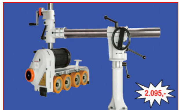
WEGOMA Variomatik 4N mit Stativ, Neugerät, CE-Zeichen, einfaches und schnelles Drehen von horizontalen auf vertikalen Einsatz, exakte Höheneinstellung durch numerische Höhenanzeige, maximale Ausladung von 1.050mm durch verlängertem Rohr, 4 Rollen, Rollendurchmesser 120x25mm, Motor 0,56kW, 380Volt, stufenlose Geschwindigkeitsregelung 2-18m/min über Handrad, Gewicht 87kg
