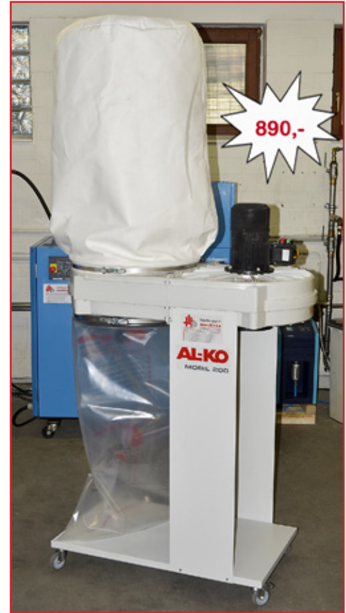
AL-KO Absauganlage Mobil 200, Baujahr 2017, Motorleistung 2,2 kW, Nenn-Volumenstrom (nach dem Abreinigen) 2.500 m³/h, Ansaugstutzen Ø 200 mm
