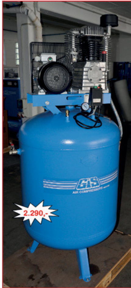
GIS 38-500/850 Vertikal, Neumaschine, CE-Zeichen, maximaler Volumenstrom ca. 850ltr./min, mit 500ltr. Kessel, Motor 400V 5,5kW, besonders ruhiger geräuscharmer Lauf durch Lang- samlauftechnik (1.150U/min)
