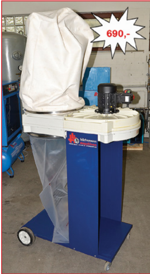
AL-KO Absauganlage mobil 140, fahrbar, Motorleistung 0,75 kW, Ansaugstutzen Ø140mm, Drehzahl 2.800U/min., Volumenstrom ca. 1.650m³/h, guter Zustand
