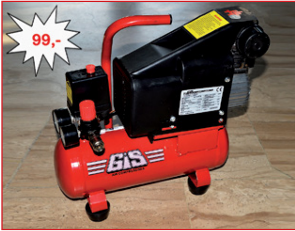
GIS GS 7/6/PF/M, Neumaschine, CE-Zeichen, maximaler Volumenstrom ca. 205ltr./min, mit 6ltr. Kessel, Motor 220V/1,1kW, Betriebsdruck 8bar, besonders ruhiger geräuscharmer Lauf, Gewicht 19,5kg, Abmessungen LxBxH 430x195x465mm
